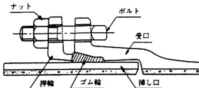
(5) 押輪の端面に鋳出している管径及び年号の表示を管と同様に上側にくるようにすること。
