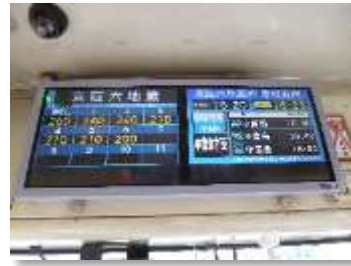
OBCビジョン (多機能液晶表示器 [画像/音声案内])
