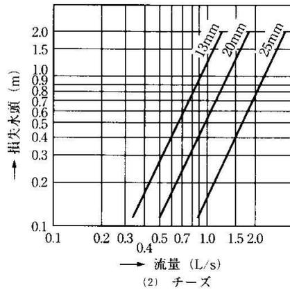
図 4-18 管継手部の損失水頭図
