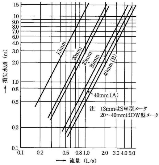
図 4-16 メータの損失水頭図
