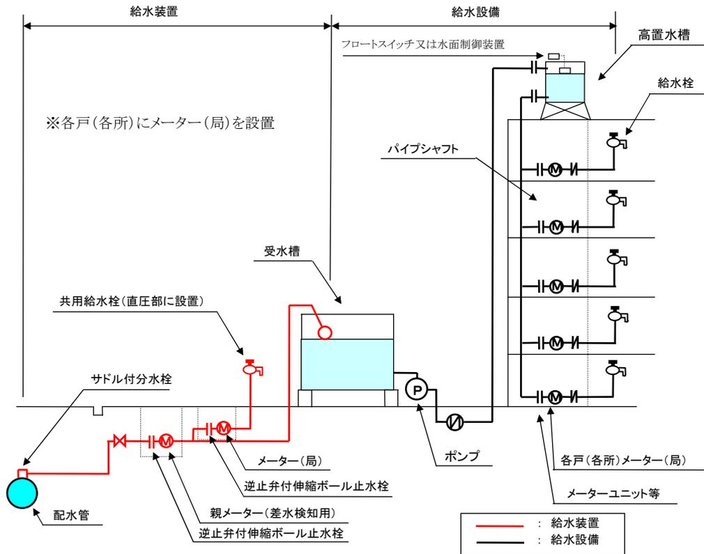
図 4-4 受水槽式給水の例(高置水槽式)
