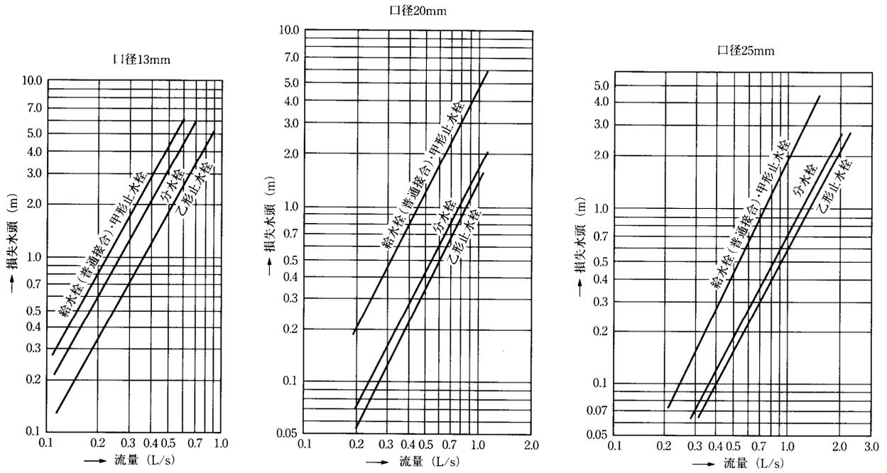
図 4-12 給水栓、止水栓、分水栓の損失水頭
