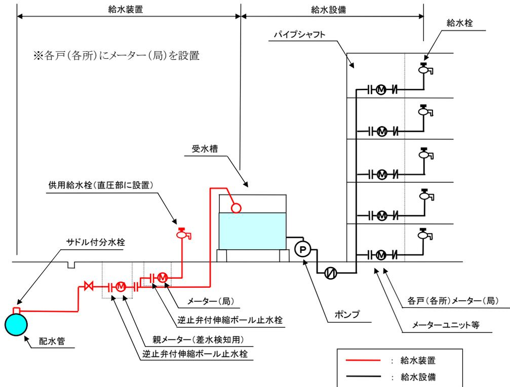
図 4-6 受水槽式給水の例(ポンプ直送式)
