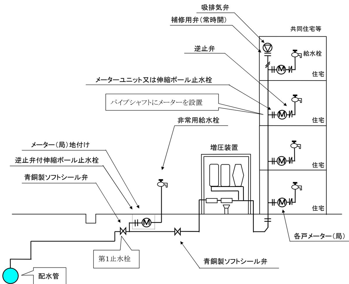
図 4-3 直結増圧式給水の例(共同住宅等)
