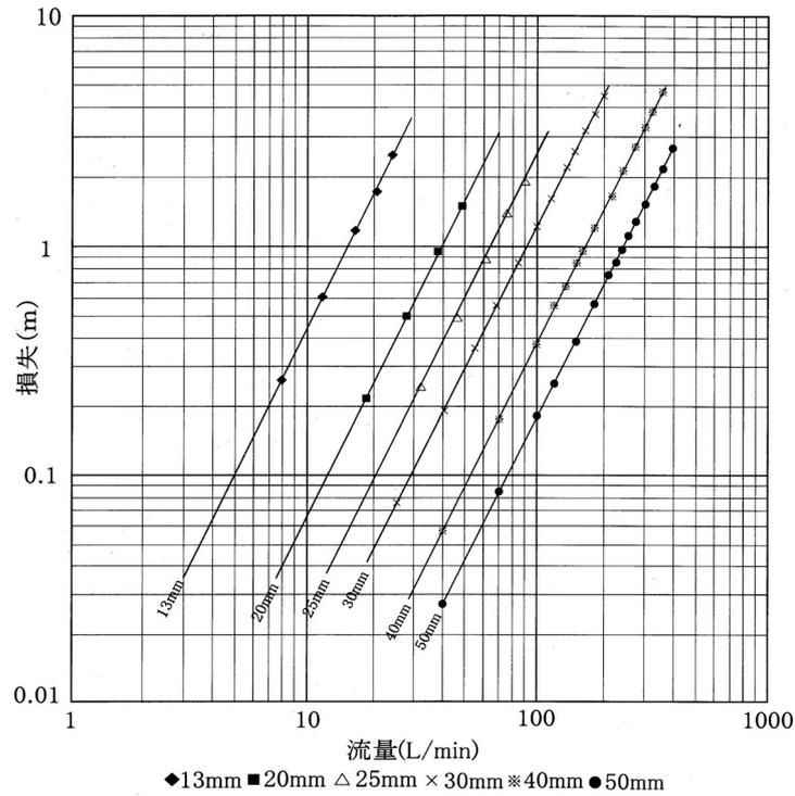
図 4-13 サドル分水栓の損失水頭図
