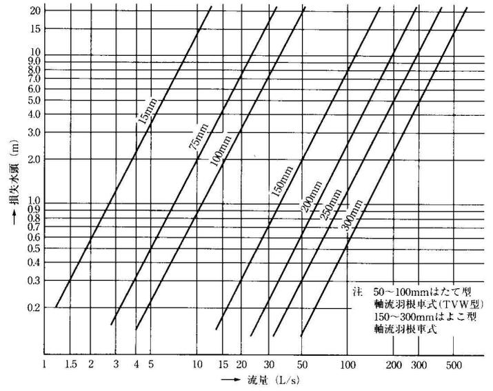
図 4-17 大口径メータの損失水頭図
