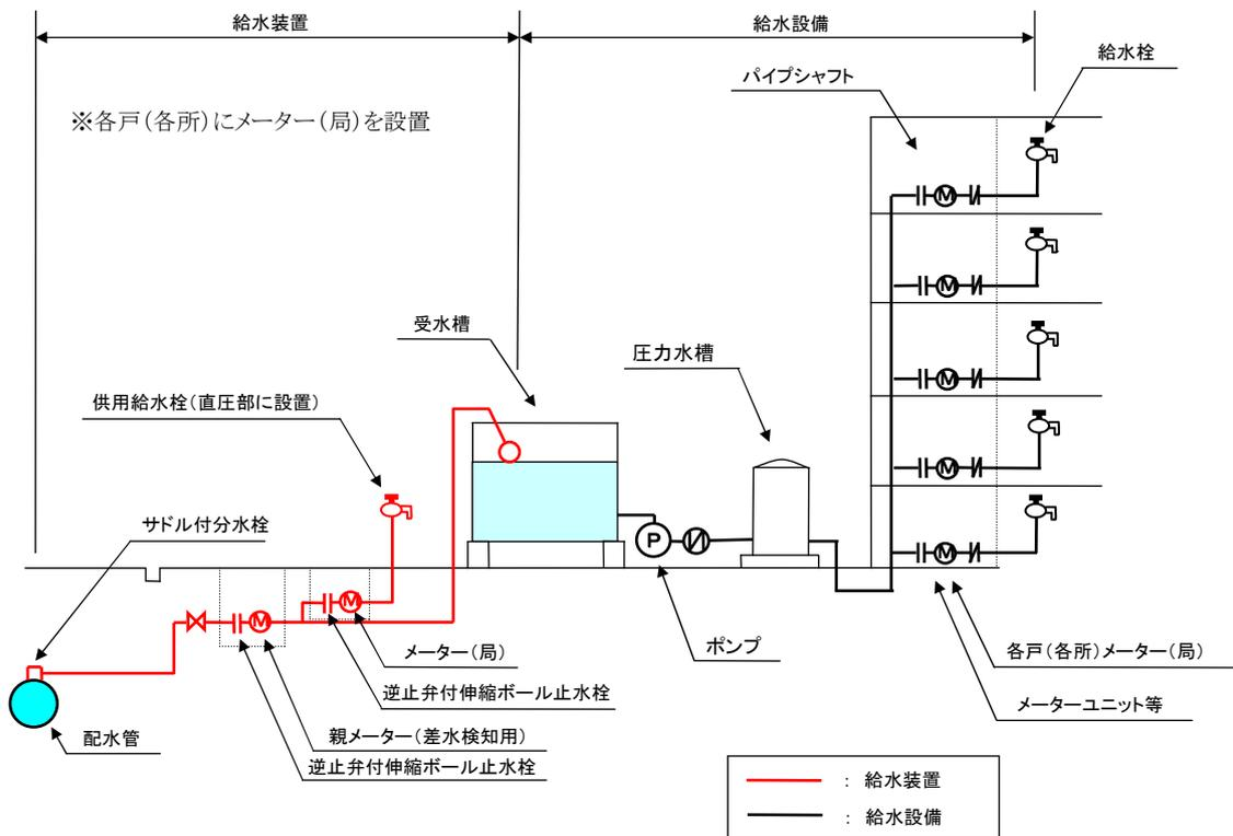
図 4-5 受水槽式給水の例(圧力水槽式)
