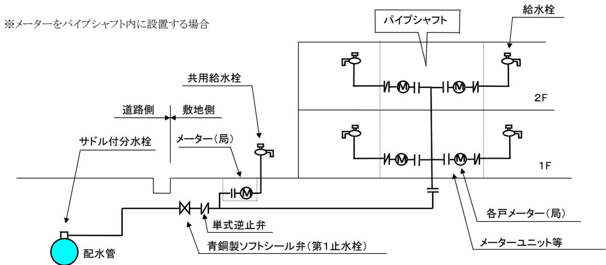
図 4-2 直結直圧式給水の例(共同住宅等)
