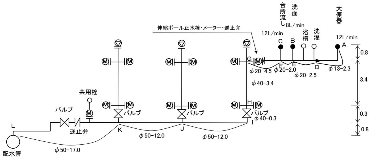
(2) 直管換算長による計算 (動水勾配はウエストン公式の簡略式を使用)
