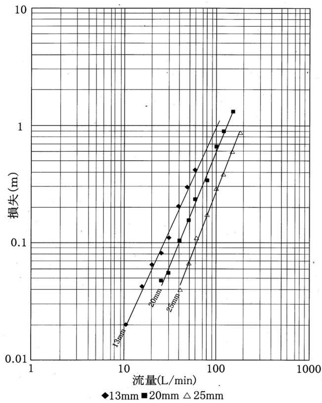
図 4-15 ボール止水栓の損失水頭図
