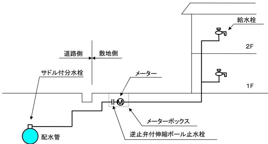
図 4-1 直結直圧式給水の例(専用住宅)
