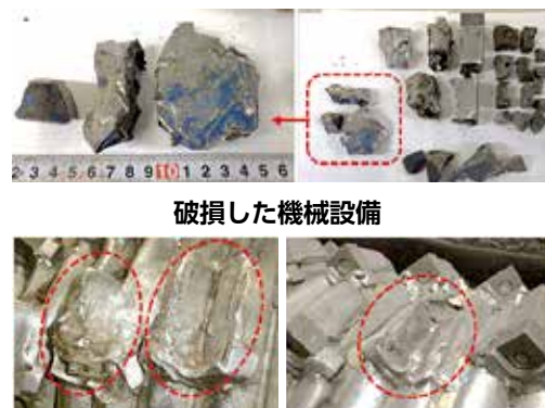
混入した金属片と破損した機械設備の破片
