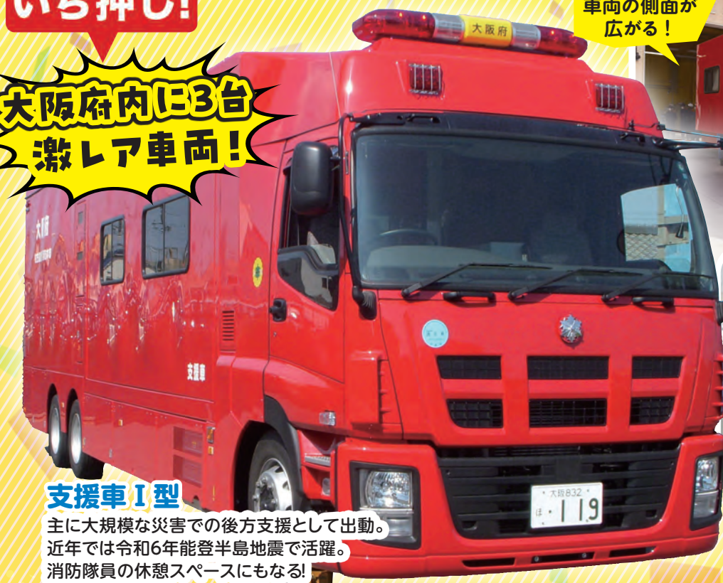
全長：11m 全幅：2.5m（拡幅時：4.0m） 車高：3.7m 乗車人員：16人
