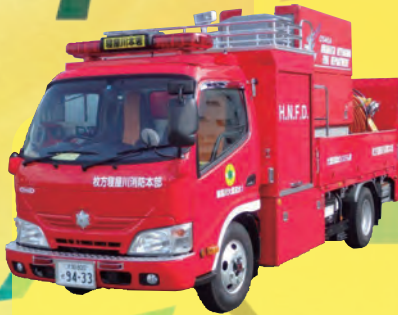
レア度 ★★★★★ 大量送水車 1分間に4,500リットル（お風呂23杯）の水を送水・排水！
