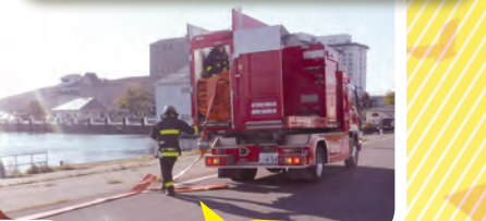
全長1kmの大型ホースを積載！走行しながらホースを伸ばします！
