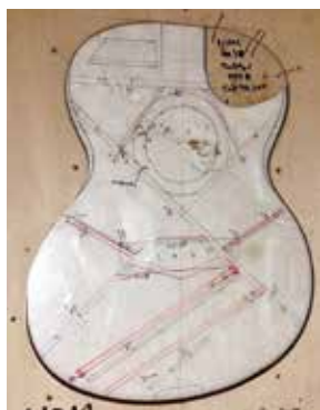
よりよい響きを求めて本体内部に貼り付ける力木の「設計図」
