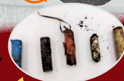
火災原因となったリチウムイオン電池
