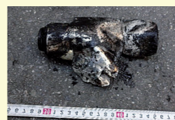
火災原因となったスプレー缶
