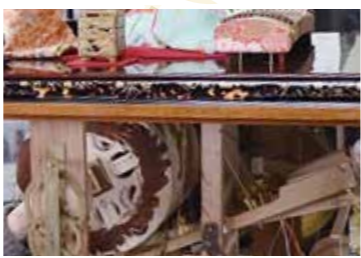
▲「琴弾き人形」の仕掛け。カム(左)が回転することで腕木(右)が上下に動き、人形を制御する。
