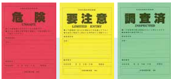
応急危険度判定ステッカー
