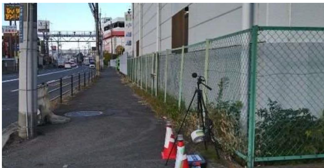
図 2-3. 2. 4 道路騒音測定の様子
