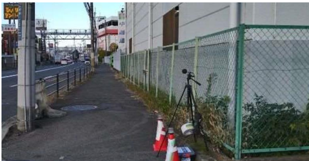
図 2-3. 2. 4 道路騒音測定の様子
