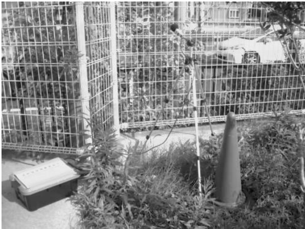
図 2-3. 2. 4 道路騒音測定の様子
