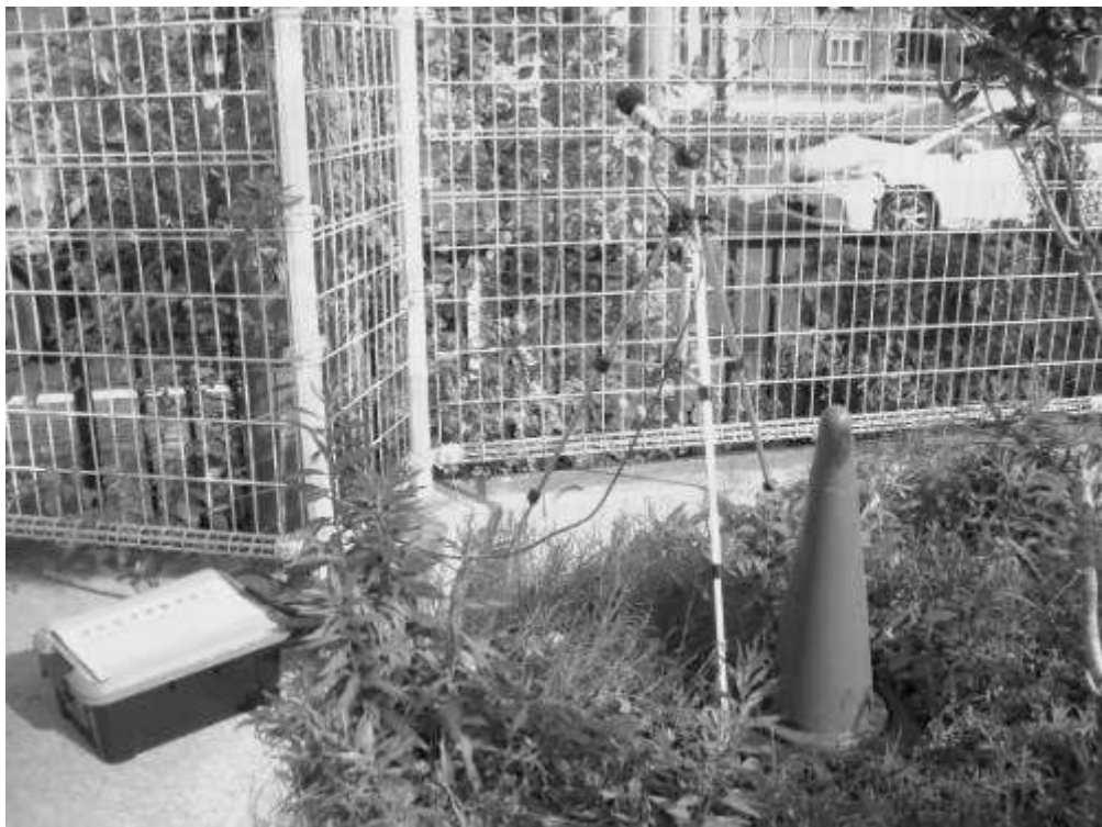
図 5. 2. 4 道路騒音測定の様子
