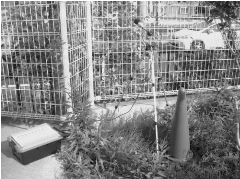
図 5.2.4 道路騒音測定の様子
