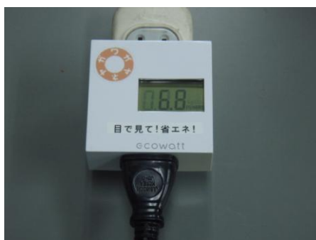
図13 電力測定器（エコワット）
